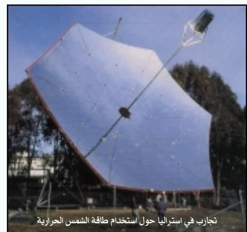
تجارب في استراليا حول استخدام طاقة الشمس الحرارية لإنتاج الكهرباء وذلك خلافاً لانتاج الكهرباء من الطاقة الضوئية للشمس
